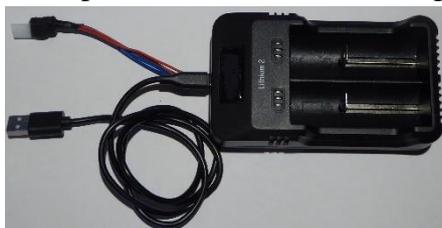
Ladegerät mit angebauter Buchse für zwei separat zu ladende Akkus
